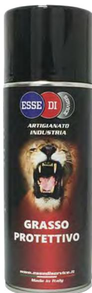
Il Grasso Protettivo è un compound di silicone ad alta viscosità . E' un ottimo protettivo contro l'acqua e l'umidità. E' particolarmente indicato per la protezione di centraline e connessioni elettriche. Temperatura d'impiego -50°C +220°C. Il prodotto è composto da una base di olio di silicone e solvente.
