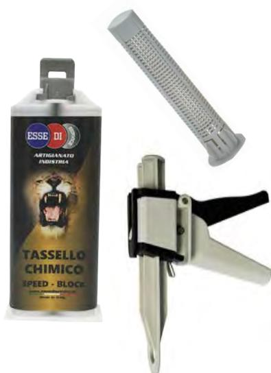
Sostituisce ogni genere di tassello tradizionale. Garantisce ottimi valori di fissaggio su: Calcestruzzo compatto e fessurato, cemento, cemento spugno, cartongesso, polistireni e polistirolo, mattoni pieni e forati, marmi, arenarie, legno e metallo. Può essere usato con viti truciolari e metriche, permette il fissaggio passante. Può essere impiegato su superfici bagnate.
